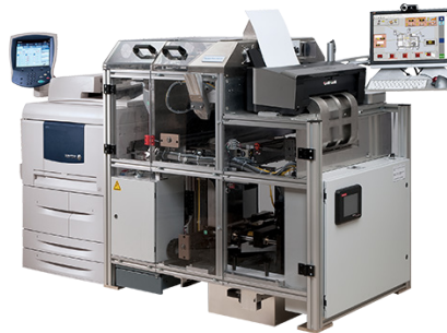
fig. 4 L'Espresso Book Machine, conçue par Xerox, est une machine aux parois transparentes qui permet d'imprimer, de relier et de massicoter un livre à la demande en l'espace de 15 minutes. Créés par la société Xerox et commercialisés à l'international par la firme américaine On Demand Books, une soixantaine de ces systèmes sont en activité dans le monde en 2016. Une machine coûtant environ 68 000 euros, la rentabilité de ce dispositif est donc limitée aux structures importantes. En mars 2016, les Presses Universitaires de France (PUF) ont ouvert à Paris la première « librairie express » d'Europe. Dans ce magasin, le robot peut imprimer sur papier n'importe laquelle des 5 000 références du catalogue des PUF. (source de l'image : xerox.com)
